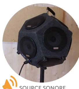
La mesure est effectuée en activant une source de bruit spécifique dans l'environnement émetteur et en mesurant les niveaux de pression acoustique dans les deux environnements (émetteur et récepteur). Le pouvoir insonorisant est donné par la différence des deux niveaux mesurés. Par conséquent, plus la valeur  $R_w$  est élevée, meilleures sont les performances d'isolation acoustique de la stratigraphie.
